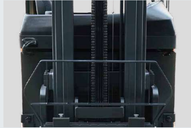
Optimum direk genişliği ve hortum yerleşimi sayesinde net bir görüş sağlar.
