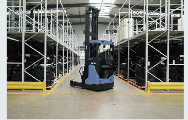
Yeni nesil tasarıma sahip şasisi sayesinde çok daha dar dönüş yarıçapı sağlar.
